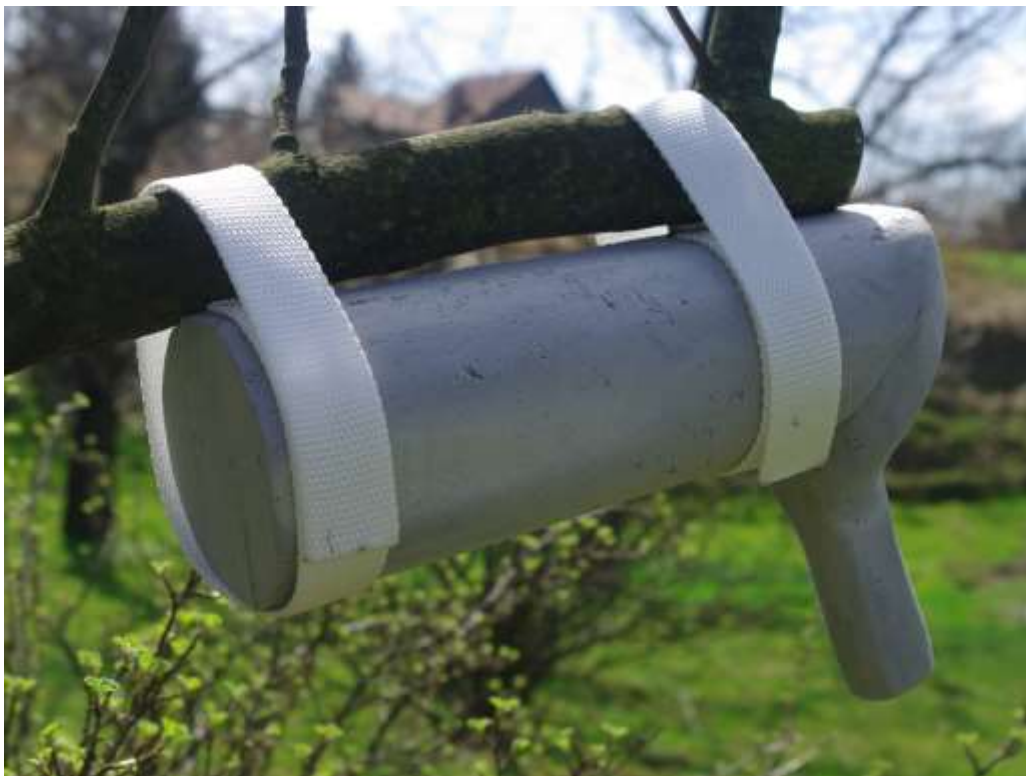
Rysunek 27 Testowanie wybranego rozwiązania – mocowanie do gałęzi, źródło: opracowanie własne
