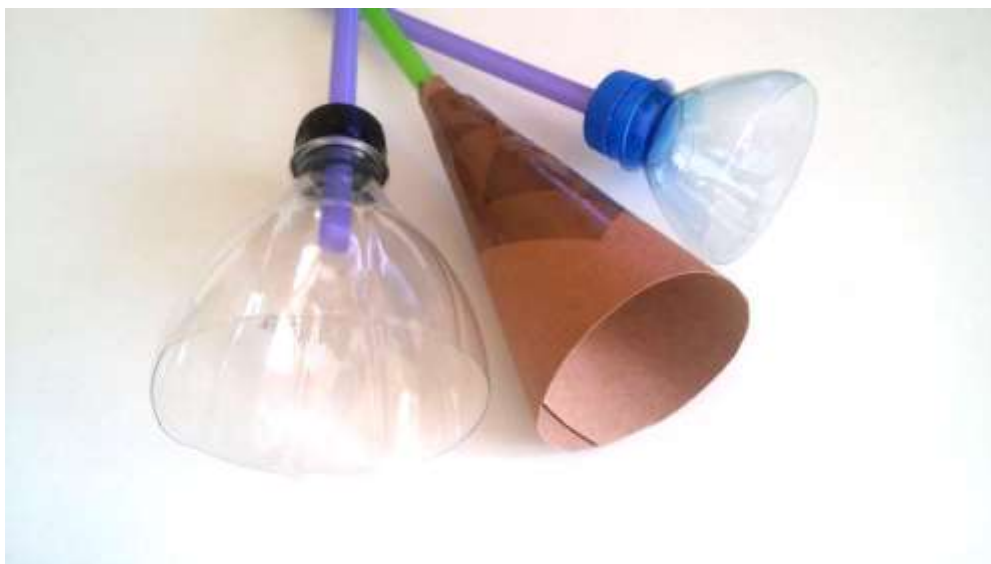
Rysunek 11 Próbne czasze do mikrofonu kierunkowego, źródło: opracowanie własne
