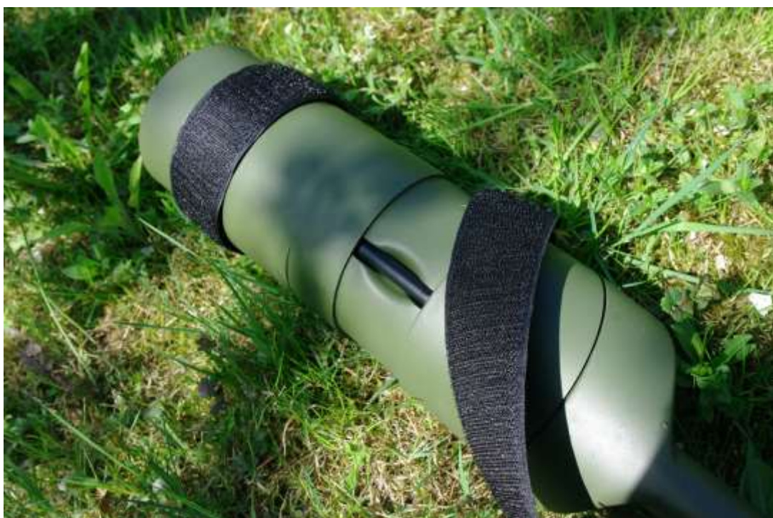
Rysunek 36 Gniazdo na endoskop znajdujące się pod trokiem, źródło: opracowanie własne
