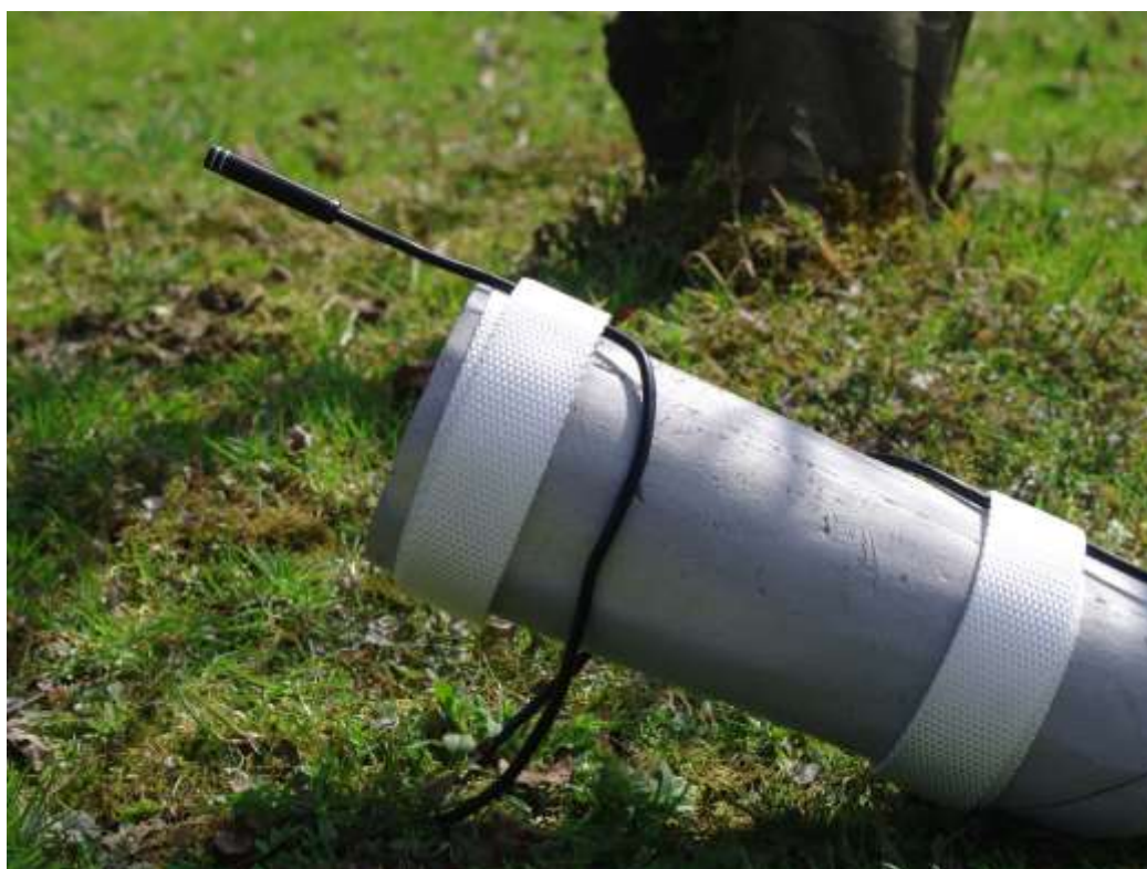
Rysunek 28 Testowanie wybranego rozwiązania – stabilizacja kamery i użycie jej usztywnianego przewodu do podparcia urządzenia, źródło: opracowanie własne
