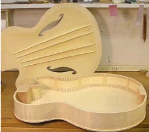
il. 60 Żebrowanie gitary typu archtop
